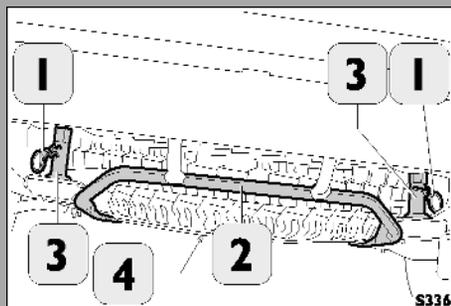
На автомобилях с одиночными задними колесами запасное колесо можно достать сзади, а не сбоку. Его можно извлечь, отвернув гайки крепления колеса к кронштейну. На некоторых модификациях фургона и комби запасное колесо находится внутри автомобиля. Чтобы достать его, необходимо открутить центральную гайку-барашек.
