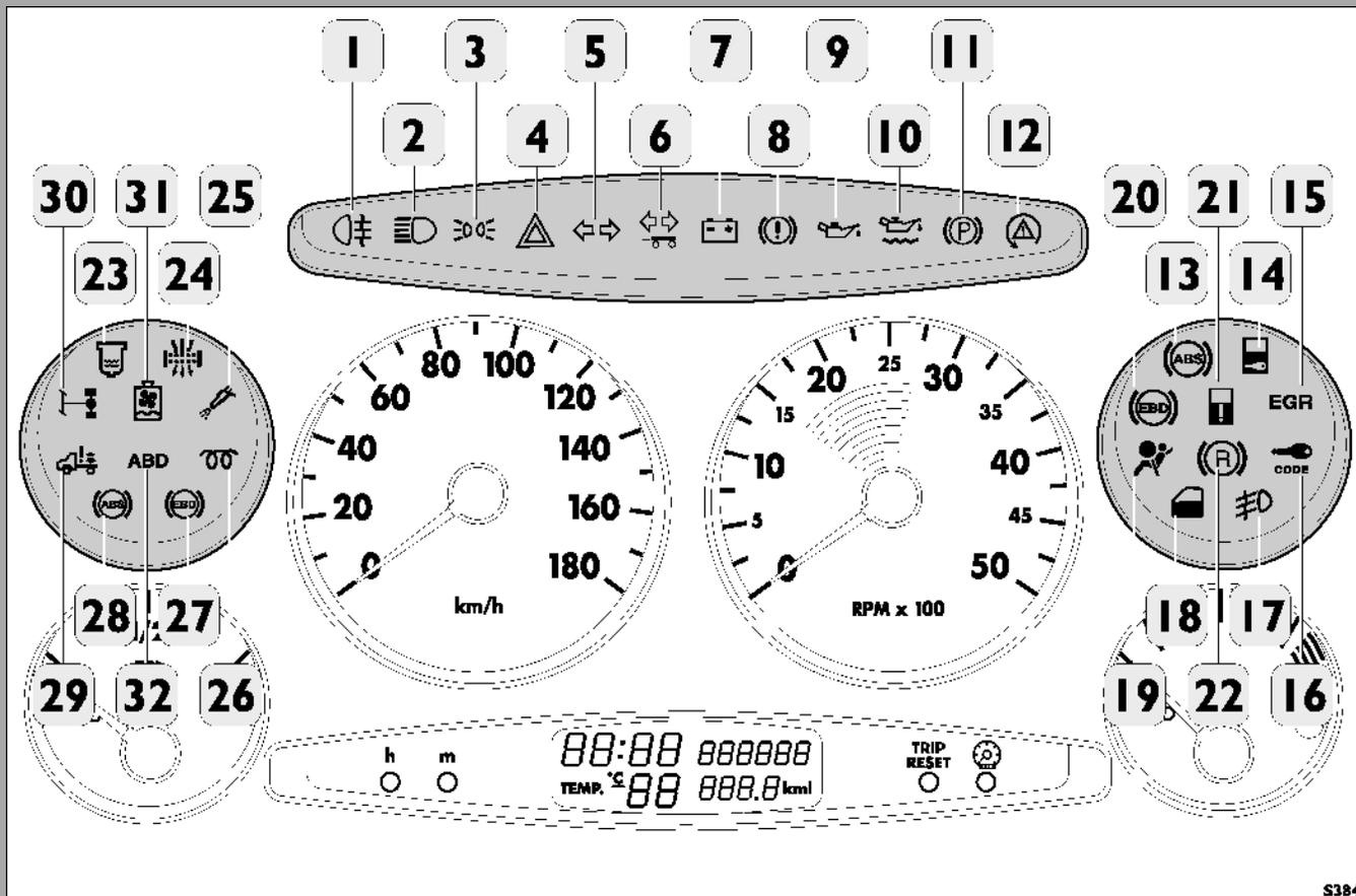
\* Бортовой компьютер автоматически проверяет работоспособность контрольных ламп, помеченных звездочкой. Поэтому при каждом запуске двигателя они загораются на несколько секунд.
