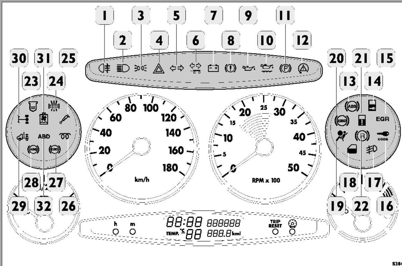
\* Бортовой компьютер автоматически проверяет работоспособность контрольных ламп, помеченных звездочкой. Поэтому при каждом запуске двигателя они загораются на несколько секунд. Некоторые контрольные лампы, отвечающие за функции дополнительного оборудования, могут быть не установлены на Вашем автомобиле — это зависит от комплектации.
